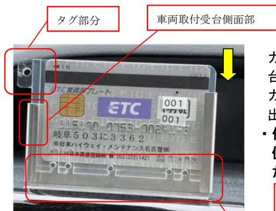
カードが格納された保管用カードケースを車両取付受台に挿入し、通し番号が合致した時だけ、下端部までカードを差し込むことができ、上方向にカードが押し出される仕組みです。
