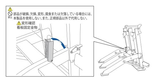
3 矢印板取り付け金物部のリングに、矢印板飛散防止対策用フックを掛けます。
